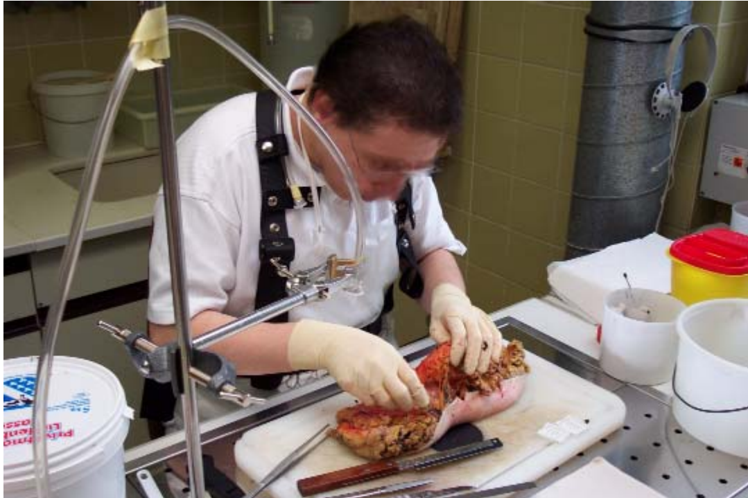
Bild 2: Einseitig abgesaugter Zuschneidearbeitsplatz
