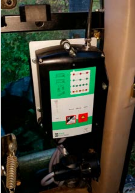
Empfangseinheit einer PNA-Forst in einer Rückemaschine
