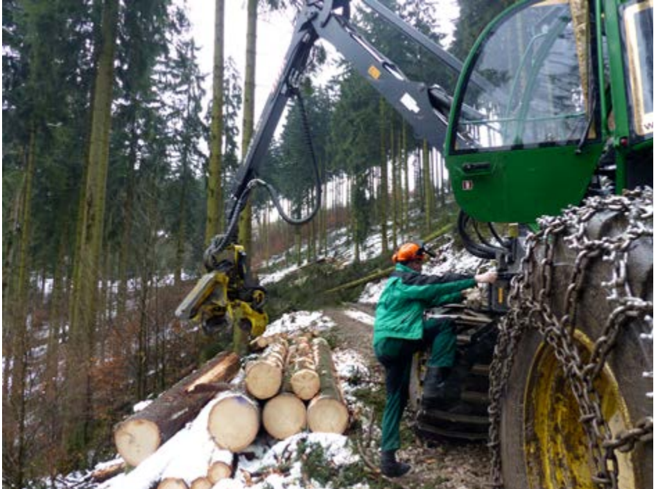
Oft unterschätzt: die Absturzgefahr beim Ein- und Aussteigen, besonders bei ungünstigen Witterungs- und Umgebungsbedingungen
