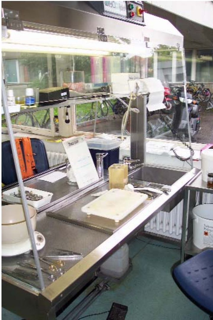
Bild 4: Gebläseunterstützter Arbeitsplatz mit Absaughaube
