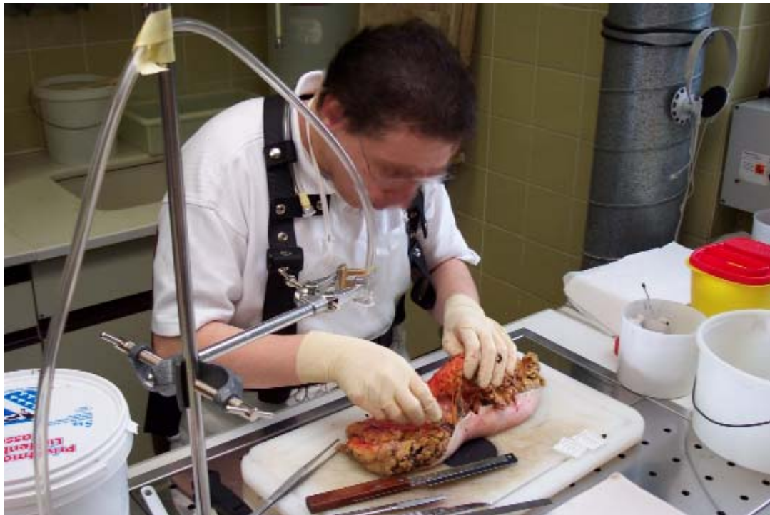
Bild 2: Einseitig abgesaugter Zuschneidearbeitsplatz
