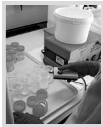
Foto 2: Befüllen von Probengefäßen mit einem Dispenser
